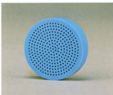
センイ・毛髪・輪ゴム・タバコの吸殻・ビニール・藻などの除去に特に効果的です。メディアに厚み (9.5<sup>m</sup>/m) があり、テーパ穴の内面は滑らかに仕上げているため、メディアポケットにたまったセンイは逆洗により簡単に除去できます。
