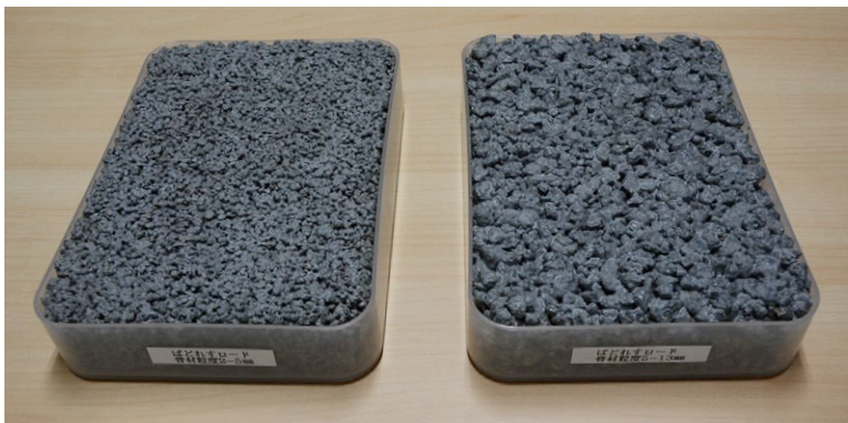
鉄鋼スラグを再利用した道路舗装材「ぼどれすロード」
