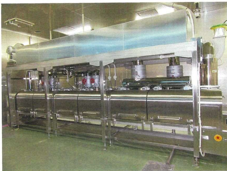
同社は大型加熱蒸気調理器のパイオニアでもある。焼く・解凍する・蒸す・炊く・揚げ る・煮るといった幅広い用途があり、水産・食肉・総菜工場などに導入されている (画像提供：清本鐵工)
